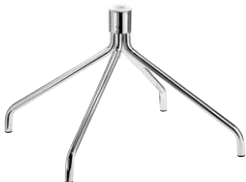
Base ELBA in tubo Ø 22x2mm - H 380mm senza perno per tappi o portaruota diagonale 700 mm
