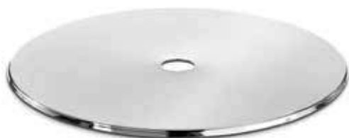
Base LIDO zincata + copertina inox AISI 430 - spess. 0,8mm circolare lucida o satinata - Ø 390/470/600/750mm
