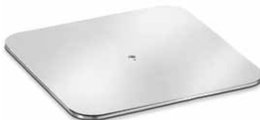
Base SALINA spess. 8mm - 450x450 copertina inox AISI 430 spess. senza spalla 0,8mm - lucida o satinata - altre misure a richiesta
